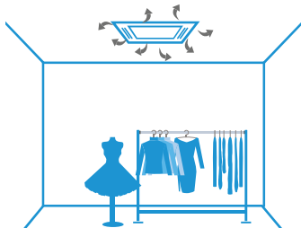
Distribution de l'air avec un filtre encrassé
