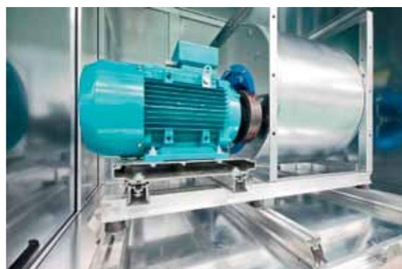
Illustration 6 : Vue détaillée de l'ensemble ventilateur-moteur (moteur décalé)
