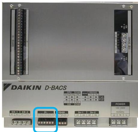
Il est possible d'arrêter les différents systèmes VRV (R410a ou R32) raccordés à la passerelle Bacnet par via un contact venant d'un système tiers (exemple : alarme incendie externe).
