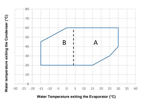
Fig. 6 – EW(W/H)T-Q Operating limits
